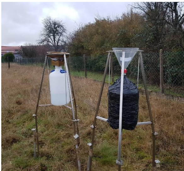
Figure 2. - Photographie de jauges Owen pour métaux (gauche) et PCDD/F ; PBDD/F (droite)
